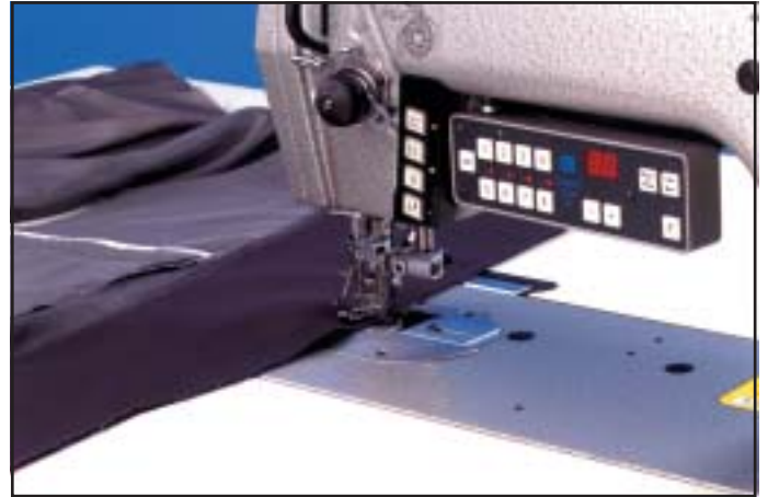
E 101 Nähen und gleichzeitiges Beschneiden der Stoffkanten, z. B. Sakkovorderkante nähen und beschneiden E 102 E 104 Sewing and simultaneous trimming of fabric edges, e.g. jacket sew and trim front edges Pour couture et rasage parallele des bords, coulissage et rasage des fourreaux
