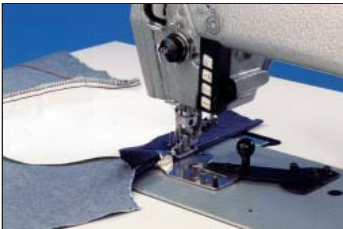
E 11 Linke Schlitzleiste an Jeans ankappen Felling left fly piece of jeans Rabattage du coté gauche de la braguette sur jeans
