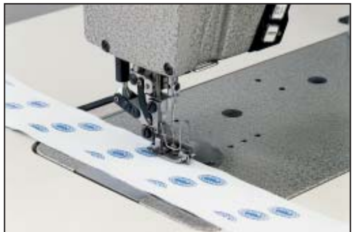
E 4 Kragen und Manschetten vornähen Runstitching collars and cuffs Coulissage des cols et poignets
