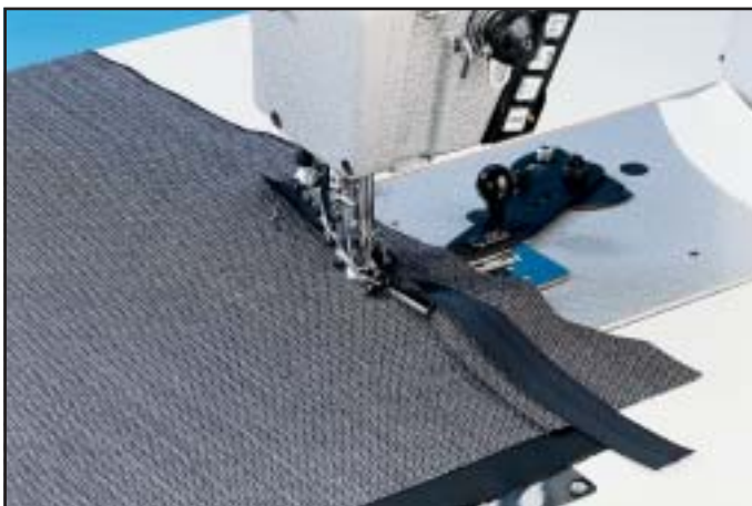
E 5 Hosenschlitzverarbeitung: linke Schlitzleiste ankappen (Bild) und rechte Schlitzleiste annähen Processing trouser flies: felling the left fly piece (photo) and attaching the right flypiece Confection des braguettes: rabattage du côté gauche de la braguette (photo) et pose du côté droit de la braguette
