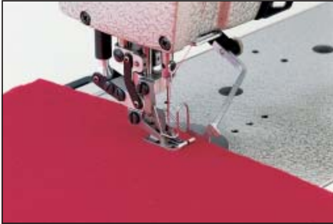
E 1 Montagenähte mit und ohne Mehrweite in leichtem und mittelschwerem Nähgut Assembly seams with and without fullness in light and medium-weight material Coutures de montage avec et sans embu dans des tissus légers à moyens
