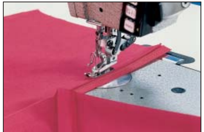
E 13 Reißverschluß einnähen und übersteppen Setting and stitching over zippers Montage de fermetures à glissière et surpiquage
